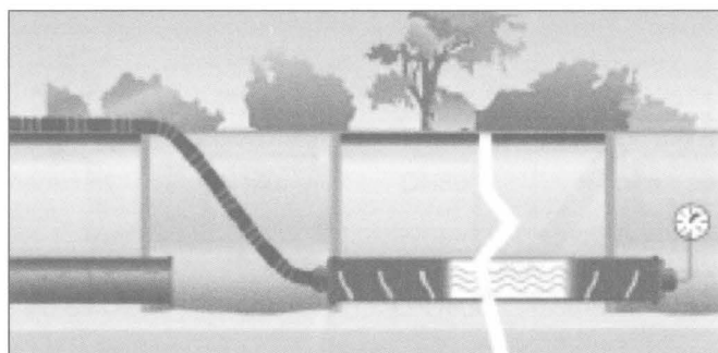
Fig. 2.13.9.B. Introducerea apei sub presiune.
