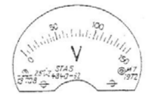
Fig. 5.53 Cadranul unui voltmetru magnetoelectric.
