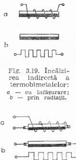
Fig. 3.20. Încălzirea mixtă a termobimetaleslor: a — cu înfășurare; b — prin radiație.
